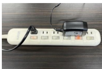
図60 一般的な節電タップ（個別スイッチ付）
